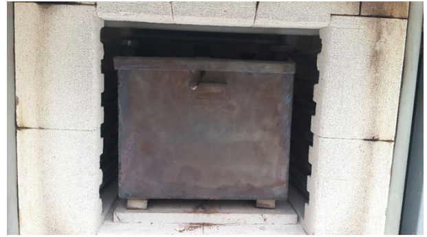
Şekil 2. Biochar üretimi için özel imal edilmiş kabın kül fırını içerisindeki görüntüsü Figure 2. Image of the specially manufactured container for biochar production inside the muffle furnace)
