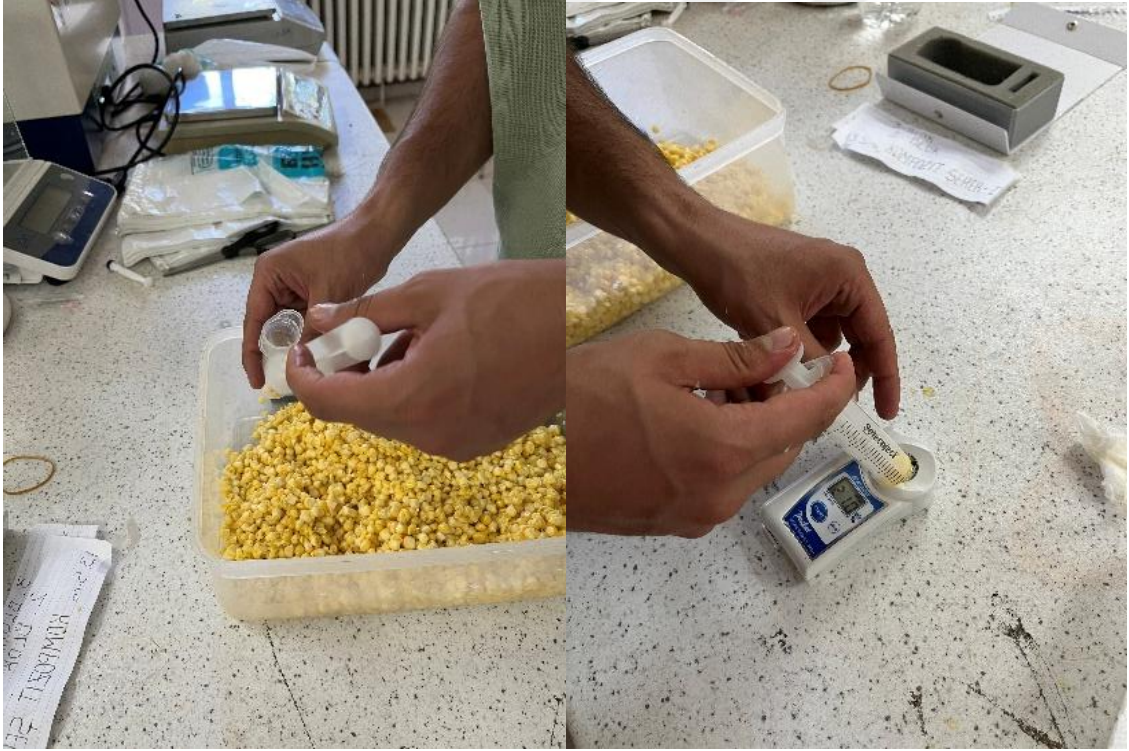
EK 13. Çeşitlerin suda çözümlü kuru madde değerlerinin refraktometre ile ölçülmesine ait görseller ( ^{\circ} Brix)
