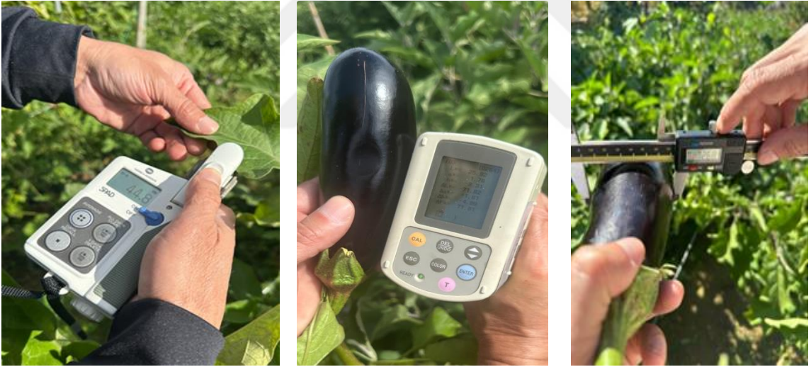
Şekil 3.8. Yaprak klorofil içeriği (SPAD), meyve kabuk rengi ve meyve çapı ölçümleri
