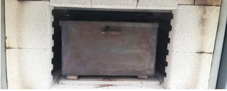
Şekil 1. Biyoçar üretimi için özel imal edilmiş çelik kap
