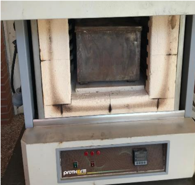
Şekil 3. Biyokömür üretimi yapılan kül fırını
