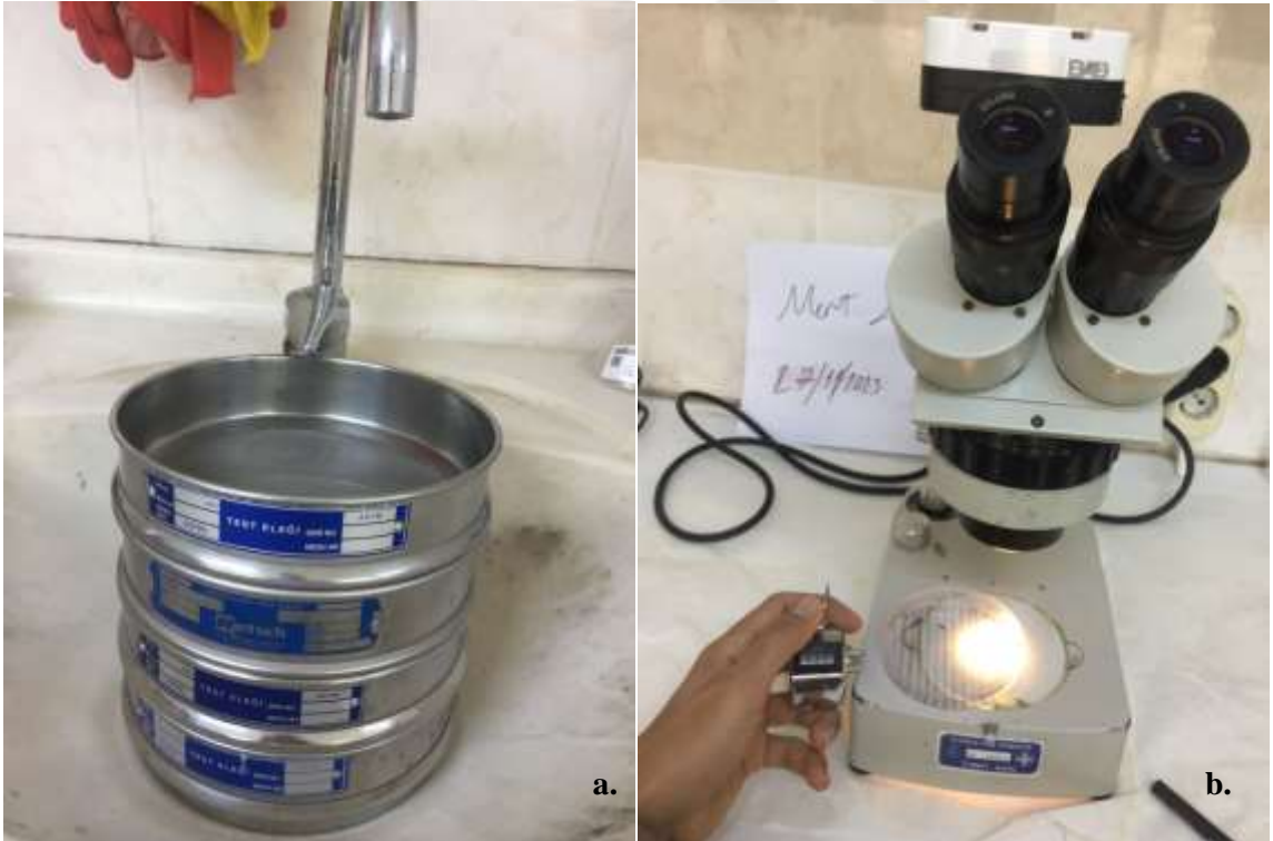
Şekil. 3.2. a) Mikoriza izolasyonu için kullanılan test elekleri, b) Stereo mikroskop ile spor sayımı
